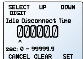
Configuración de un tiempo de desconexión por inactividad del Modbus.
